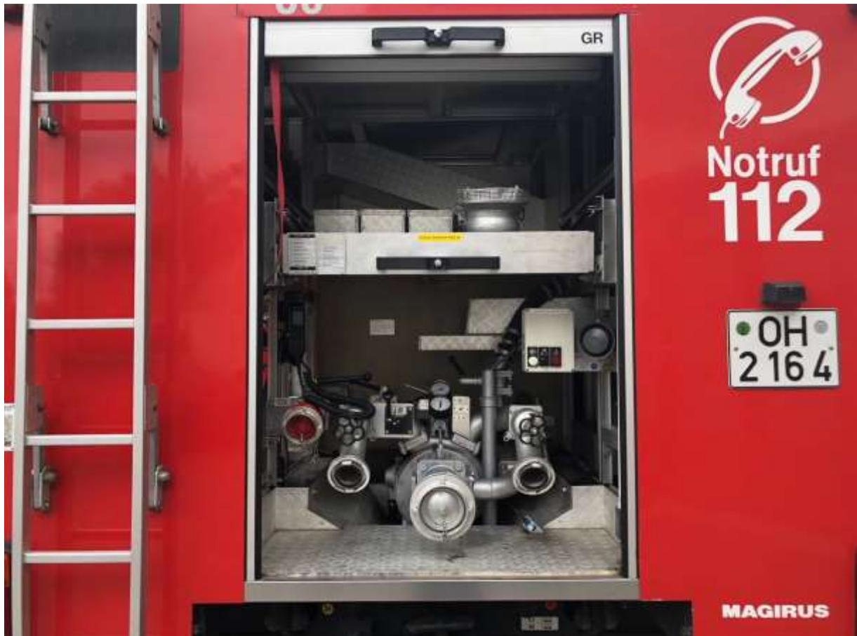
Fahrzeugheck mit Pumpe und Wassertank
